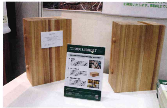
写真4 展示されていたDLT これは長谷萬さんの製品です。CLTと違い、接着剤を使用しない、木ダボ材の摩擦だけで材を繋げています。能登の震災では被災地などでもこの材が使われています。建築家の坂さん（※5）が災害公営住宅などにも採用しているので、話題になっている材料ですね。（勝田）
