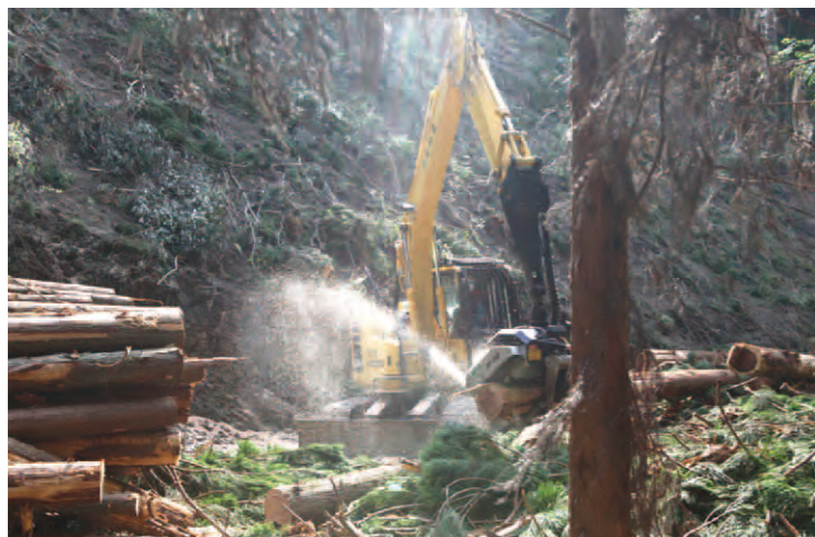
施業現場で集材に力を発揮するフォワーダー。丸太をピックアップして積載する
