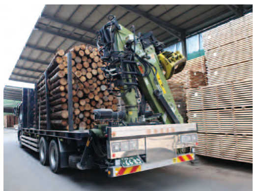
施業現場で集材に力を発揮するフォワーダー。丸太をピックアップして積載する
