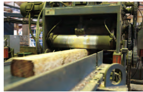
USNR製シャープソー タイコ挽きした丸太を、曲がりながら1度に12個の丸鋸で製材する
