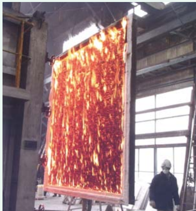
1時間加熱後取り外した際のウッドエーエルシー裏面
