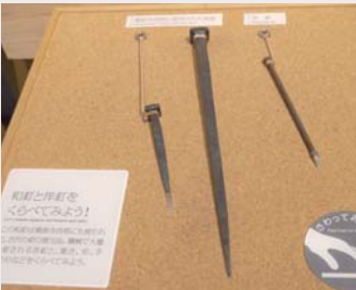
和釘と洋釘の比較。左2本が和釘で、薬師寺西塔に使われた古代の釘の復元品。重さ、形、手触りなど、手に触れてみる事が出来ます。
