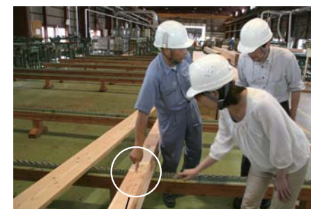
写真-6 フィンガージョイント部
