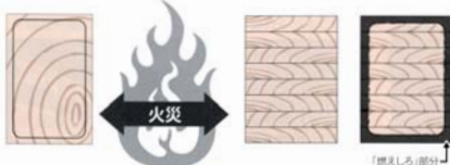
図-4 燃えしろ設計 (「集成材のはなし」日本集成材工業協同組合より)
