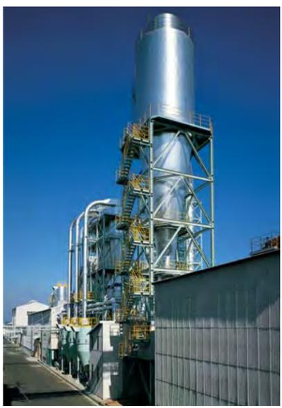
写真5 製造工程【解繊】の最後の工程、ドライヤー
