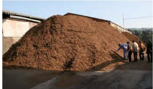
写真2 工場内のチップヤード。合板・製材工場からの端材が原料のチップの山
