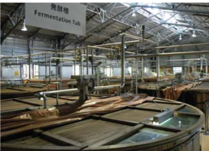
ダグラスファーで作られた発酵槽の巨大な木桶
