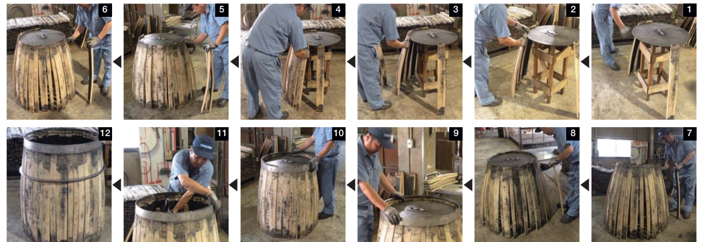
1～8 4本の足をもった台に載せた仮輪を中心に側板を並べていきます。側板は大きさも幅も曲がり具合も少しずつ異なっています。 9～11 鉄輪（かなわ）を載せ、側板を足で軽く叩きながら形を整えていきます。ここまでは瞬時の仕事でした。
