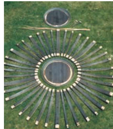
ウイスキー樽を解体して並べた樽材。上部 と中央に置かれた円形の樽材が鏡板。中央 の鏡板の周囲に側板が並べられている
