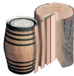
図-5 柁目取り 中心の髄から樹皮に向かって放射状に切り出す。この方法で切り出すと、オーク材を縦横に走っている導管と放射組織が樽材の表面に顔を出さない。
