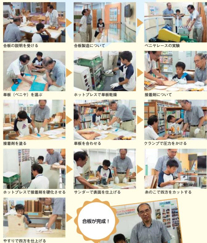
合板の説明を受ける 合板製造について ベニヤレスの実験 単板(ベニヤ)を選ぶ ホットプレスで単板乾燥 接着剤について 接着剤を塗る 単板を合わせる クランプで圧力かける ホットプレスで接着剤を硬化させる サンダーで表面を仕上げる 糸のこで四方をカットする やすりで四方を仕上げる
