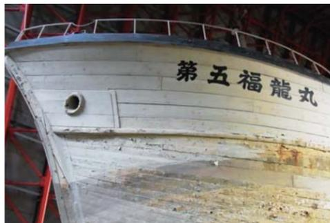
第五福竜丸は1947年建造。当時、戦争による徴用で船はほとんどなく、漁用の船もGHQの許可が必要で、許されていたのは木造100トンまで。許可後140トンに作り直された。当時の木造の用型船として現在、船体が残されているのは第五福竜丸の1隻だけ。木造船の歴史資料としても貴重な遺産。
