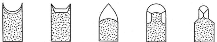
図4 インサイジング刃形の一例
