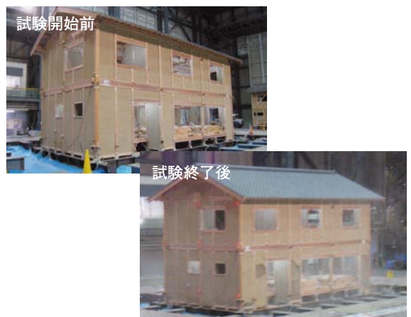
伝統的木造軸組構法の実物大住宅性能検証振動台実験
