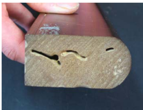
木粉・プラスチック複合材のシロアリ食害
