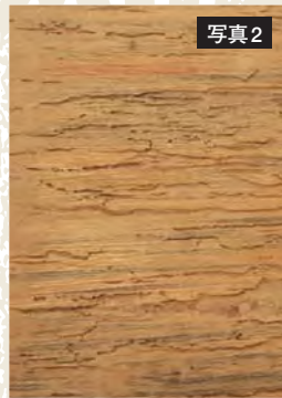
ヒラタキクイムシの幼虫に食害されたラワン合板
