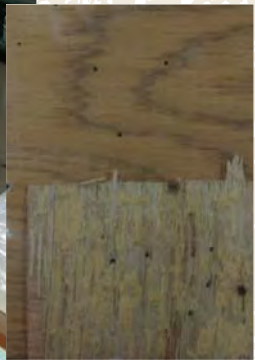
成虫が抜け出した穴。手前の小片は内部の被害材
