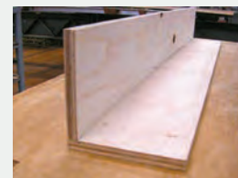
写真3 合板DLをL型に接合した場合
