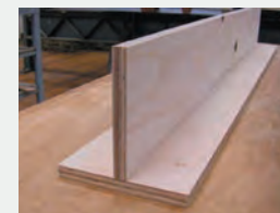
写真4 合板DLをT型に接合した場合
