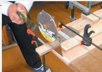
写真6 「一発カット」のソーガイドに、のこ身を差し込み、長さ寸法に正確に切断
