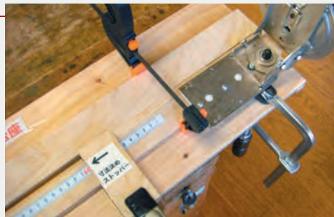
写真5 長さ寸法をメジャーとストッパーで正確に決める切断教具「一発カット」
