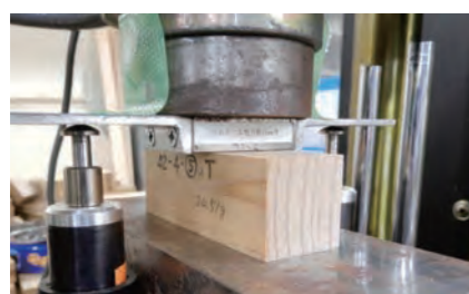
写真5 めり込み試験の様子
