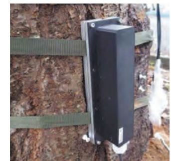
写真3 開発中の振動発生装置 木に産卵させない技術の一つで、クビアカツヤカミキリをびくつきさせる振動発生装置。産卵などの行動抑制が期待できる。現在、効果の検証中。
