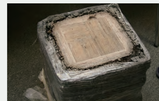
写真6 燃焼試験後の試験体 表面が炭化し内部まで火が届かない
