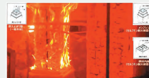
写真5 耐火試験 一般木材（左）セルフネン耐火被覆材（右）
