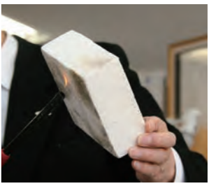
写真7 薬剤を含有した発泡ウレタン。火を近づけても発火しない
