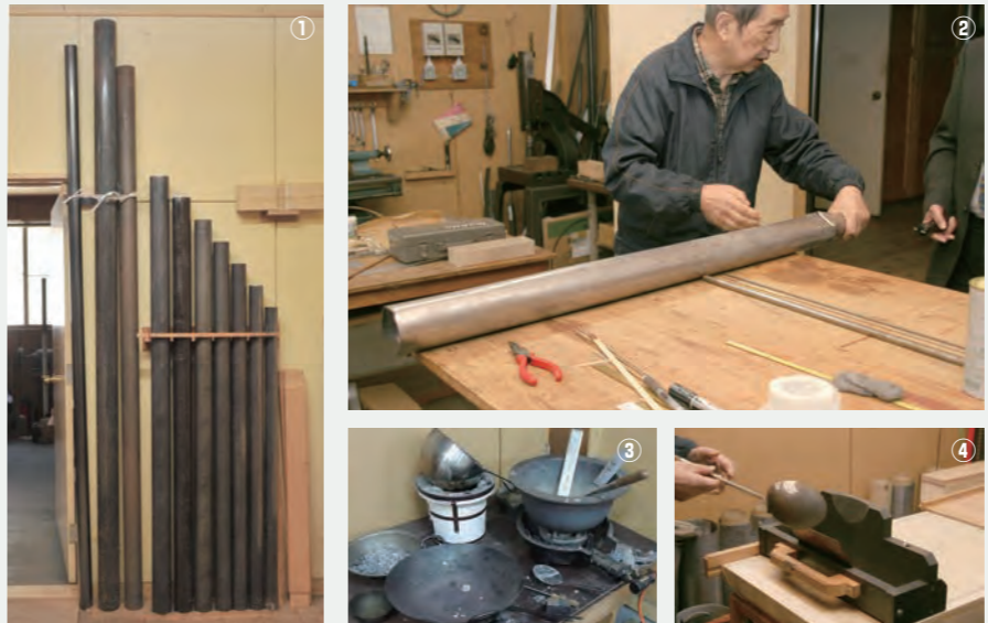
①オルガンパイプ整形用の鉄パイプ ②丸めて半田付けされた状態のパイプ ③鉛と錫を熱する道具 ④液状の鉛と錫を流し込む箱、これをスライドして板状にする
