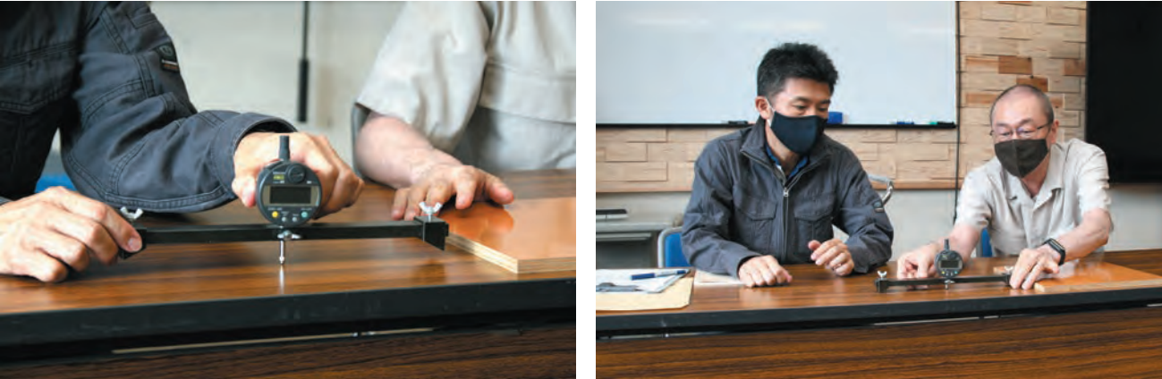
自作の平面度測定器(矢高計)
