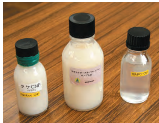
写真1 研究所内で製造されたCNF。 左からタケCNF、スギCNF、酸化処理したCNF
