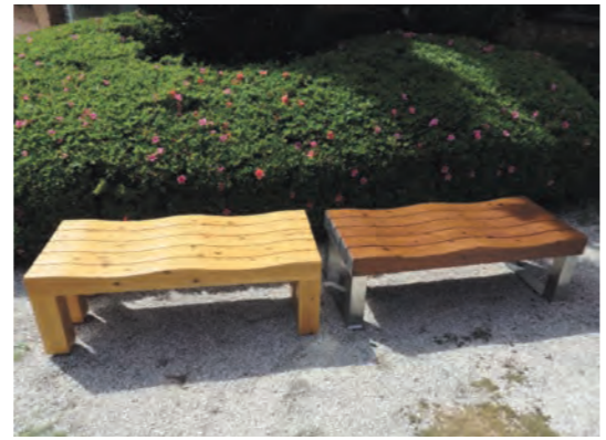
写真3 CNF配合塗料(下塗り)を使用した木製ベンチ屋内用(左)、屋外用(右)
