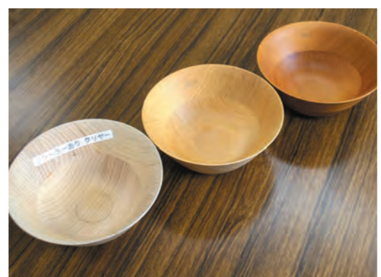
写真4 木製品の器(桐ラ・ルース提供)にCNF配合塗料を塗布したサンプル
