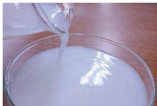
写真2 スギソーダAQパルプから酵素・湿式粉碎で製造したCNF 酵素・湿式粉碎により製造したスギ由来のCNF(1.6%の水懸濁状態)。白濁で、粘性を示します。
