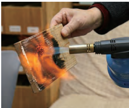
火炎放射試験を見せていただいた。表面は黒く変化するだけで、触ると消し炭は指に付着しなかった。
