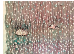
光学顕微鏡によるビスフレック(二つ)の木口面写真
