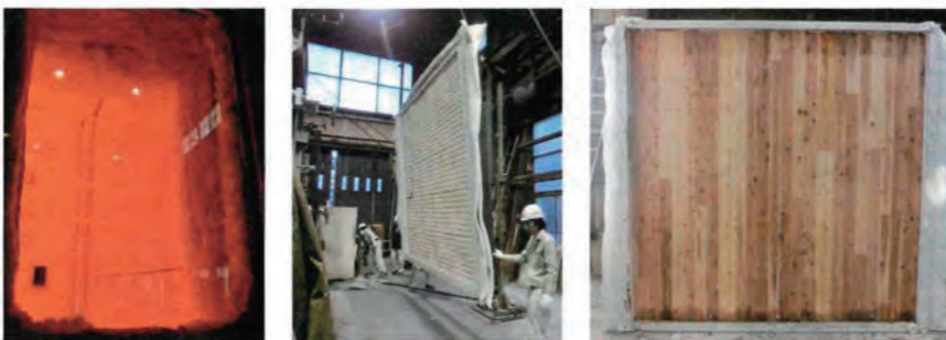
図3 石膏ボード等で被覆した国産スギCLT壁の耐火試験 耐火試験中の炉内 2時間経過時の温度は約1050℃に達する。 試験後の様子 炎や煙は見られず、被覆材の脱落も無し 試験後の内部CLT表面の様子 CLT表面に炭化は無く、十分な強度を保持した健全な状態。
