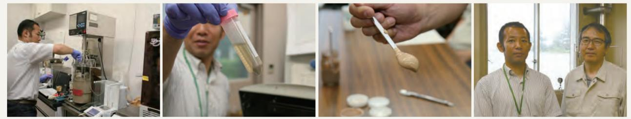
糖化発酵装置を操作する大塚主任研究員 遠心分離機で上澄みと固形部分に分離した状態 ゲル状に変化したスギ木材スラリー 左から大塚主任研究員と、野尻チーム長
