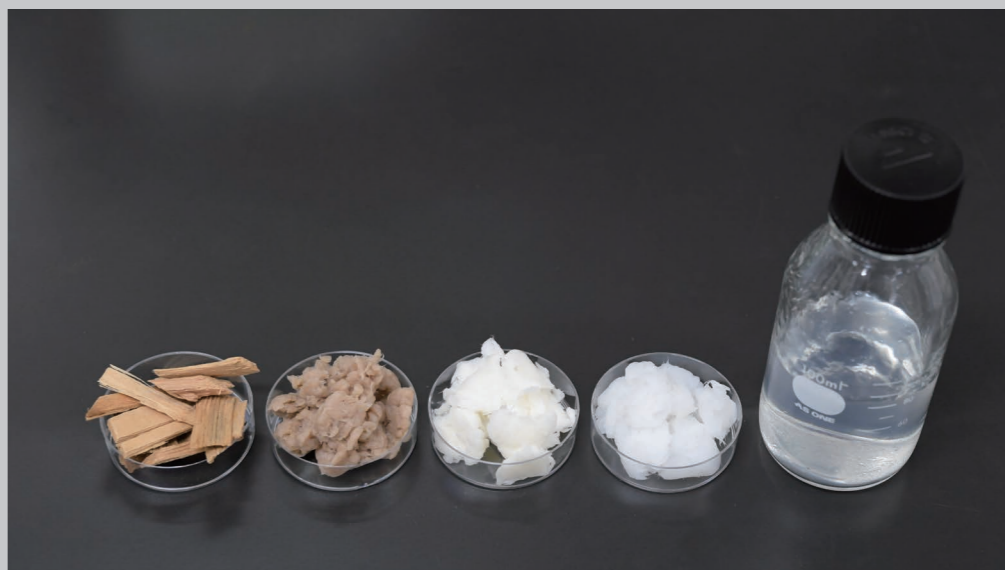
写真左から、木材チップ、パルプ、漂白パルプ、TEMPO酸化させたパルプ、セルロースナノファイバー溶液
