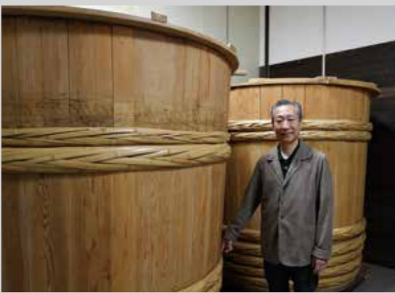
杉の仕込み桶は直径約1.8mの6尺桶が2つ。年輪にそって割った側板を、内側が赤身(心材)、外側が白太になるように組むとアルコールを通さず良い仕込み桶となる。ちなみに、桶はふたが外れる容器。樽はふたをはめ込んで密閉した輸送用の容器を言う。
