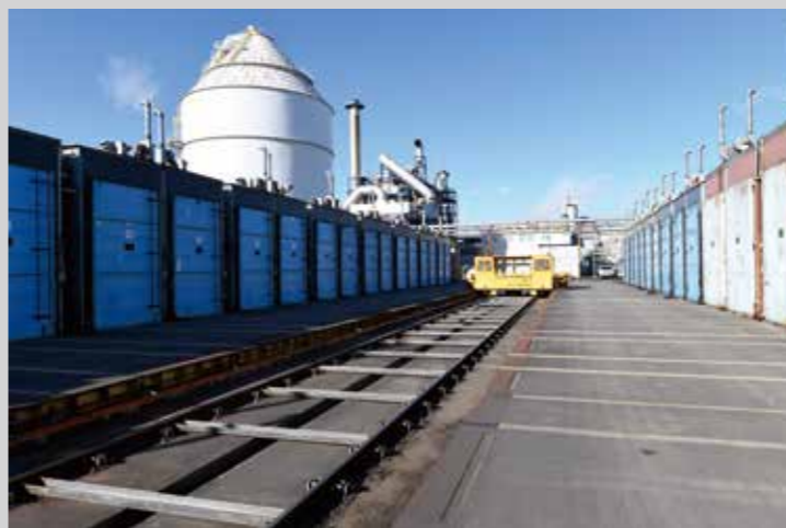
100立米の丸太が入る釜が約160並ぶ。1つの船で積んで来る丸太は約5万本。それを何回かに分けて釜に入れ乾燥させていく。
