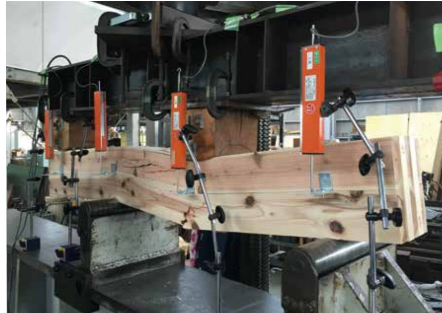
CLT せん断実験(学内施設で自作した CLT 梁)
