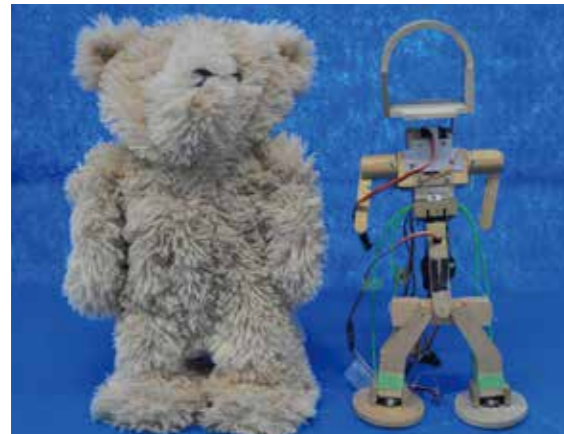
ロボティクス学科(中里研究室)による木造ロボット 比強度の高い材料特性を活かして軽量化
