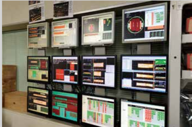
管理室のモニターでリアルタイムに丸太のスキャン画像を見ながら、オペレーターが木取りをコントロールしていく。
