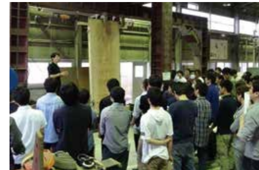
構造実験演習 面内せん断実験後の解説風景 学生達が試験体を製作し実験後は許容耐力算出の演習も行う
