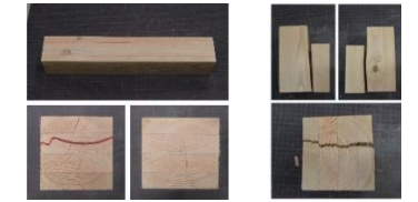
3点曲げ試験の破壊性状 実大いす型試験の破壊性状
